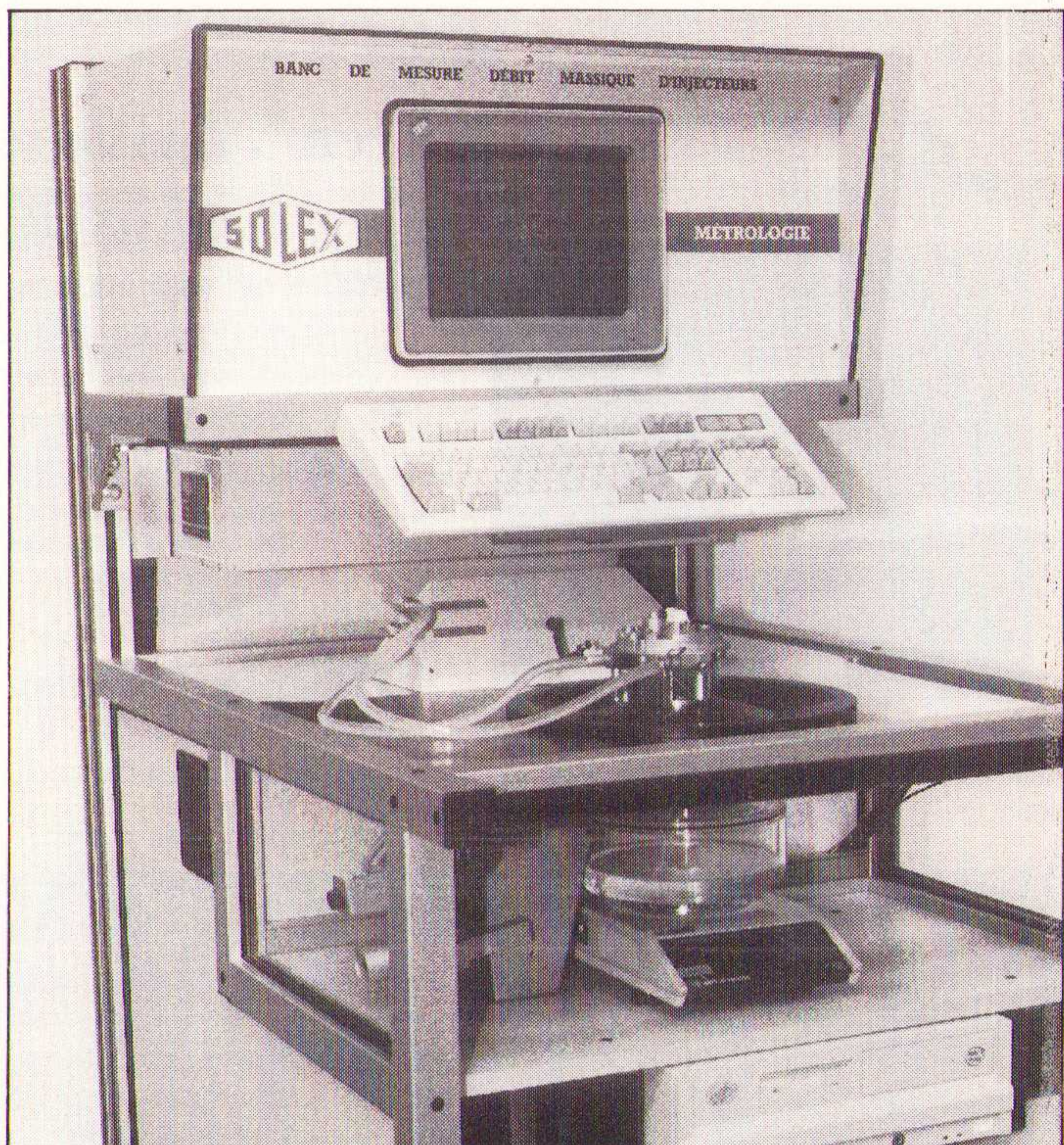
Debiet-meetbank controleert met hoge precisie.
